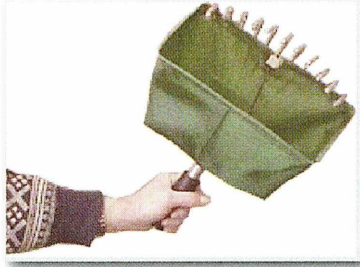
Şekil 3.6. Zeytin hasat tarağı
