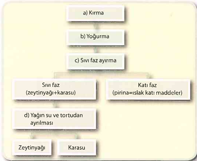
Şekil 3.20. Zeytinyağı temel üretim aşamaları
